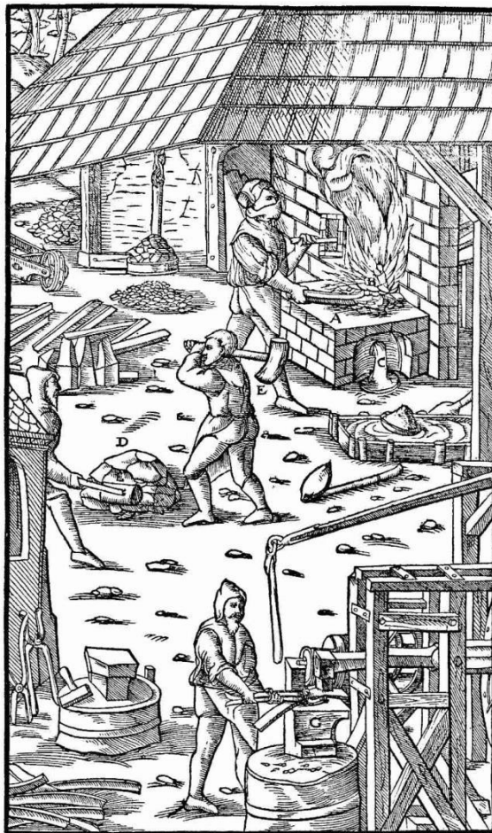
Ryc. 1. Wnętrze kuźnicy wg G. Agricoli (1556). W głębi piec dymarski.
